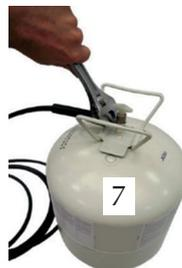
6) Raccordement du tuyau du primaire au spraytank.
